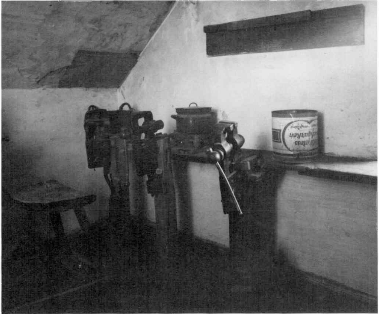
An den Schraubstöcken wurde das rohe Hornmaterial in Gußklauen eingespannt und begradigt. Im Hintergrund auf der Werkbank der Kocher zum Erwärmen des Horns.
